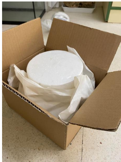
Fig. 9. Caja que sirve de aislante para la cristalización lenta (cartón, papel de filtro y recipiente de poliespán).
