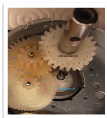
Figura 15: sistema de engranajes (ruedas dentadas) que reducen la velocidad de giro
